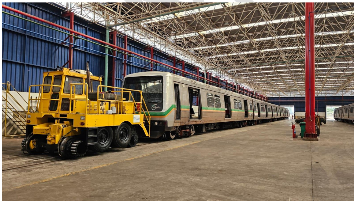
Figura 12 - Veículo utilizado para reboque de trens em manutenção.
